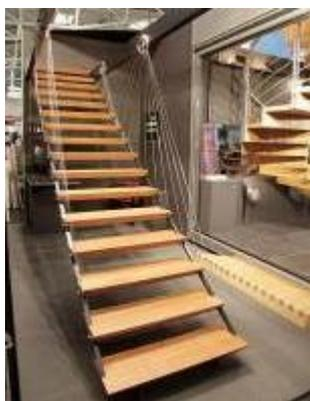
Nicht nur der Jury fiel die Hängetreppe der Zeitform-Design GmbH auf der Internationalen Handwerksmesse ins Auge. Gehalten wird die Treppe durch Zugstangen, die bündelweise in der Decke befestigt werden, sowie eine Führungsschleife, in der die Treppenstufen montiert sind. Hängebrücken standen bei der Idee des Unternehmens aus Mainleus in Oberfranken Pate. Die schwebend leicht wirkende Konstruktion wurde mit dem Bayerischen Staatspreis ausgezeichnet.
